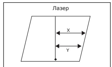
Произведите замеры (как показано на рисунке). Снятые таким образом размеры помогут точно определить требуемое количество и размеры дверей, а так же правильно оценить соответствие проёма техническим требованиям к монтажу раздвижных дверей.
