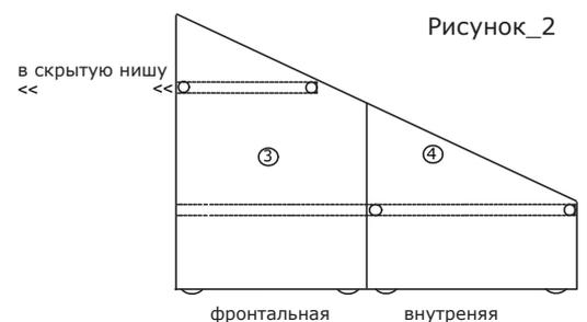
**ВНИМАНИЕ: ПРИ МОНТАЖЕ РАЗДВИЖНЫХ ДВЕРЕЙ, ДЛЯ ОПТИМАЛЬНОГО ПЛАНИРОВАНИЯ ХОДА ДВЕРЕЙ, РЕКОМЕНДУЕТСЯ ИСПОЛЬЗОВАНИЕ ПОЗИЦИОНЕРОВ ДЛЯ НИЖНИХ НАПРАВЛЯЮЩИХ 10.01.031, НЕ МЕНЕЕ ОДНОГО ДЛЯ КАЖДОЙ ДВЕРИ.**
